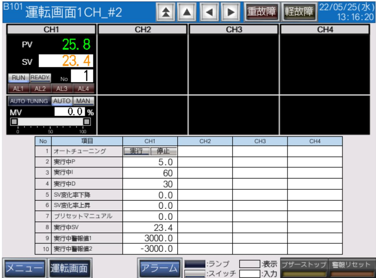
実際に SB710 を SLMP(MC プロトコル 3E)クライアント、Q03UDVCPU を SLMP(MC プロトコル 3E)サーバーとして通信した画面です。
