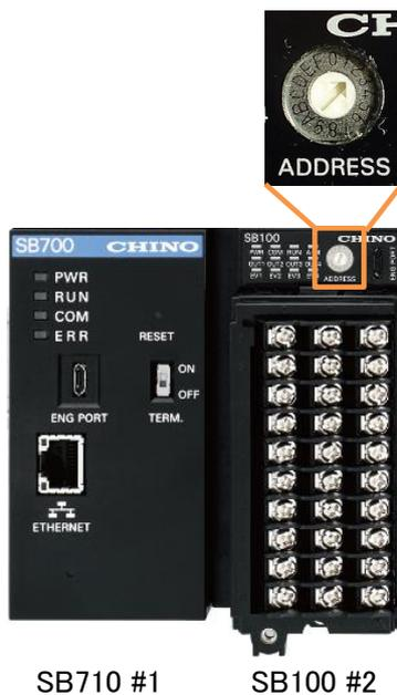
SB100 のロータリースイッチを「2」にして機器アドレス 2 にします。
