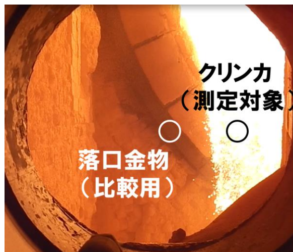
図3 放射温度計設置場所より見たキルン出口のクリンカ、落口金物と測定位置
