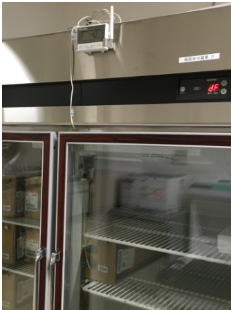
冷蔵庫への設置状況 マグネット付き取付ホルダで 装置に固定
