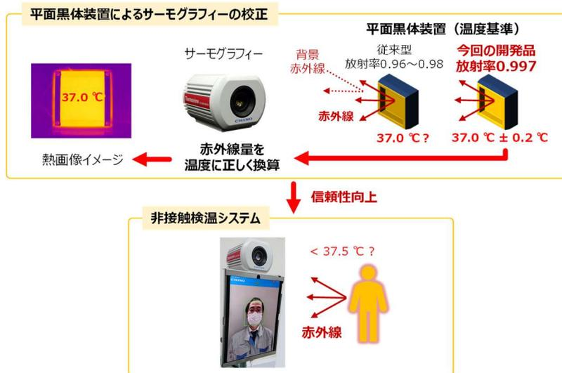
図1 平面黒体装置によるサーモグラフィーの校正と非接触検温システムのイメージ
