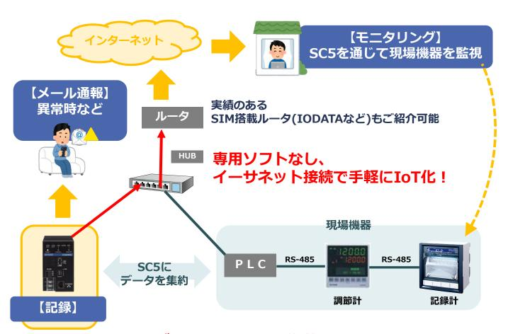
PLCからのデータをSC5へ集約することで、 メーカの違う各装置・機器も安価・簡単に監視!
